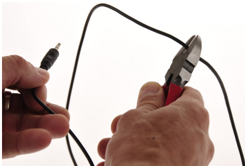
1. Kabel auf das gewünschte Maß ablängen.
