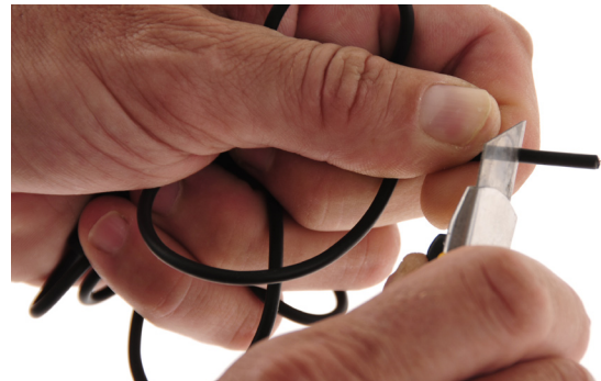
2. Außenkabel (schwarz) an den Enden jeweils ca.20 mm abisolieren.
