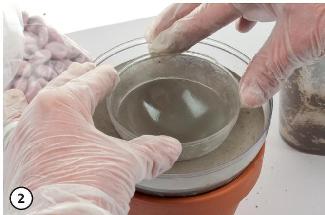
Placez la plus petite moitié de boule sur le milieu de la couche de béton. Verser du béton dans l'interstice.
