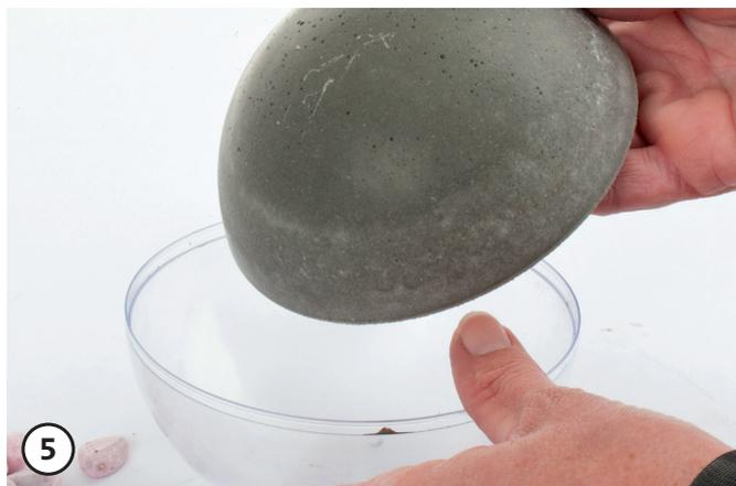
Retirez la moitié de boule extérieure. Laissez s'évaporer complètement les restes d'humidité.
