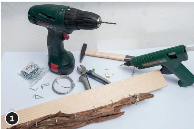
Passendes Wurzelholz aussuchen, Kiefernleiste an des Wurzelholz anpassen (Handsäge). Beidseitig, ca. 5 cm eingerückt vom Rand, je ein Loch in die Kiefernleiste bohren. Mit dem Aludraht das Wurzelholz durch die beiden Löcher an der Leiste befestigen.
