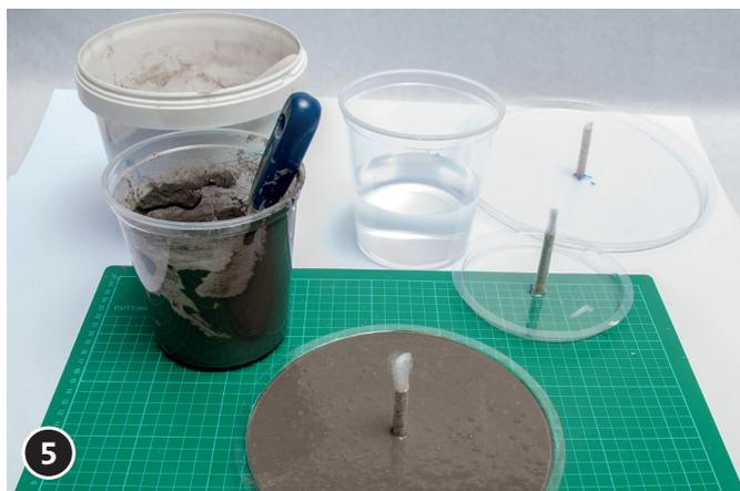
5 Effettua la colata secondo le istruzioni base per il calcestruzzo. Una volta asciutto rimuovi i tondelli di legno.
