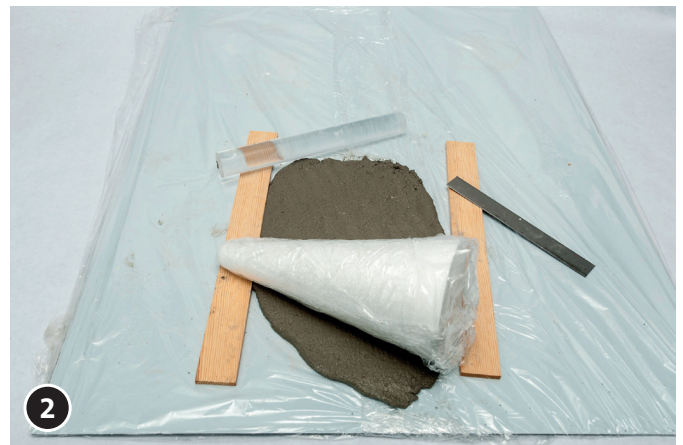
2 De tempex kegel met vershoudfolie omwikkelen. De kneebeton plaat aan de kegel plakken.
