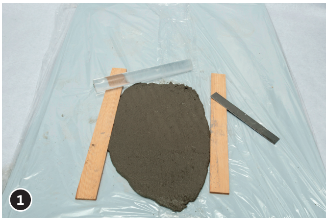
1 Kneebeton volgens de productbeschrijving mengen. Een ca. 5 mm dikke kneebeton plaat uitrollen.
