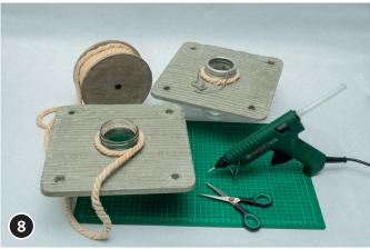
Dans les trois rondelles de béton restantes, poser le verre au milieu dans l'ouverture. Si le verre devait glisser à travers l'ouverture, alors rétrécir l'ouverture avec la corde. C'est à dire couper un bout de corde et avec le pistolet à colle, le coller tout autour du verre.
