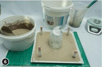
Remplir la cavité des moules (avec ou sans verre) avec le béton. Laisser sécher durant 1 à 2 jours. Démouler le béton, laisser s'évaporer l'humidité qui est rester dans le béton.
