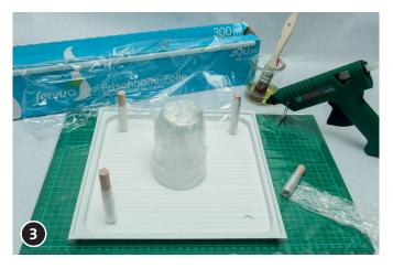
Enrouler le verre, les morceaux de bois de feuille de conservation et coller (on en aura besoin pour 3 plaques en béton). Les 5 autres plaques en béton seront réalisés sans verre mais avec 4 tiges en bois.
