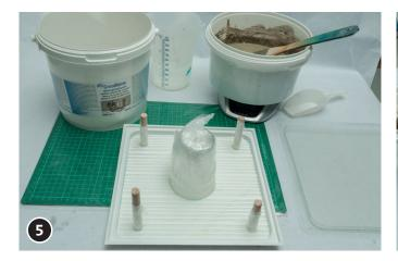
Mélanger le béton créatif conformément au mode d'emploi avec de l'eau. (Pour 8 plaques, on a besoin d'env. 12 kg de béton créatif).
