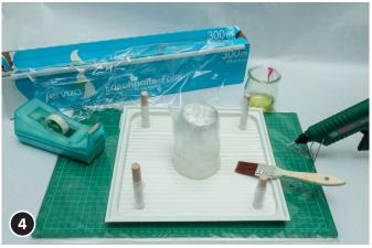
Enduire généreusement le moule, le verre et les morceaux de bois de lait latex Formalate afin de les protéger et de faciliter le démoulage ultérieur du béton.
