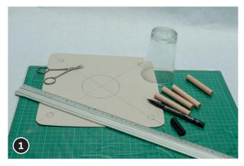
Gießform Wandplatte, Papierskizze von der Vertiefung zeichnen. Auf der Skizze mittig, mit dem Zirkel, einen Kreis (stärkster ø) für das Glas einzeichnen. Diagonaldurch die Mitte, Linien für die vier Aussparungen für die Holzstäbe (ø 10 mm) anzeichnen, Bohrungen festlegen. 4 Teile des fünften Holzstabes (ca. 8 cm Länge), für den Gießvorgang, mit einer Handsäge abschneiden.
