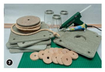
Für den Fuß fünf quadratische Betonscheiben (ohne die Aussparung für das Glas) aufeinander legen. Die vier Holzstäbe (Länge 1000 mm) in die Aussparungen stecken, satt mit 3D-Silikonkleber in den Bohrungen fixieren.
