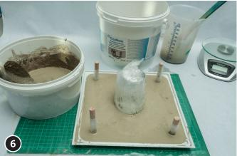
Vertiefung der Gießformen (mit und ohne Glas) mit dem Beton ausgießen. Ca. 1–2 Tage trocknen lassen. Beton entformen, Restfeuchte aus dem Beton entweichen lassen.
