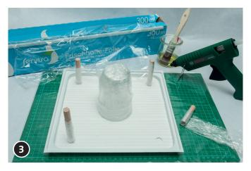
Glas, Holzstücke mit Frischhaltefolie umwickeln und festkleben (wird für 3 Betonplatten benötigt). Die 5 weiteren Betonplatten werden ohne Glas, aber mit den 4 Hölzern gefertigt.
