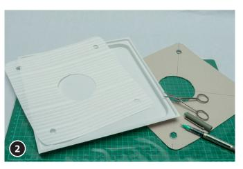
Aussparungen aus der Papierskizze ausschneiden. Strukturfolie für die Gießform aussuchen. Papierskizze auf die Strukturfolie auflegen, nachzeichnen, Aussparungen aus der Strukturfolie ausschneiden.
