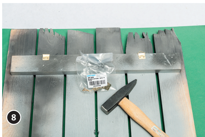
8 Para terminar, fijar los colgadores para cuadros a la parte trasera.
