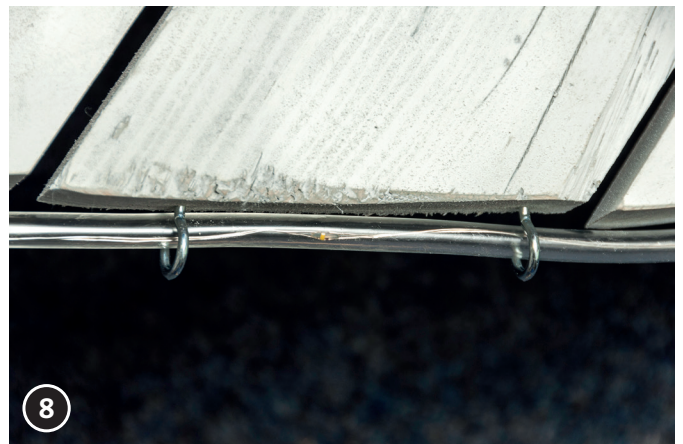
8 Enfoncer les pitons à vis de manière à ce que le tube lumineux puisse encore s'y enfiler à travers. Fixer ce tube en partant du milieu intérieur et le poser à l'extérieur. Fixer encore le compartiment à pile sur l'arête extérieure, au dos. Pour terminer, fixer encore l'étrier de fixation au dos, pour la suspension ultérieure.
