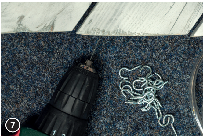
7 Prépercer des trous à des distances d'env. 10 cm avec la perceuse.
