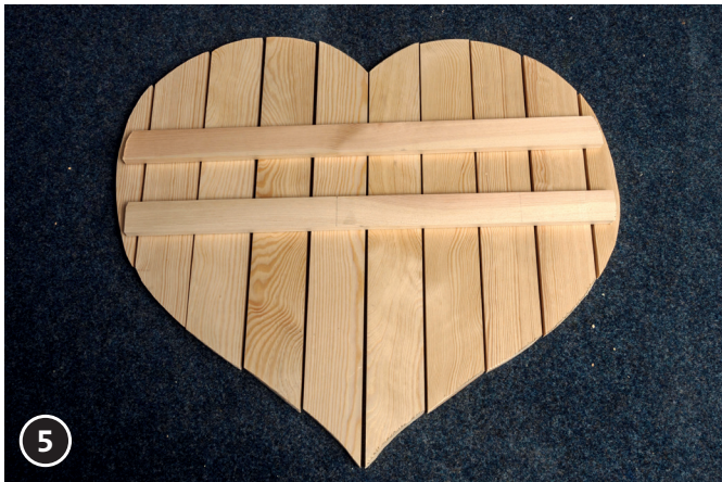
5 Fixer les lattes étroites en pin au verso avec des clous.
