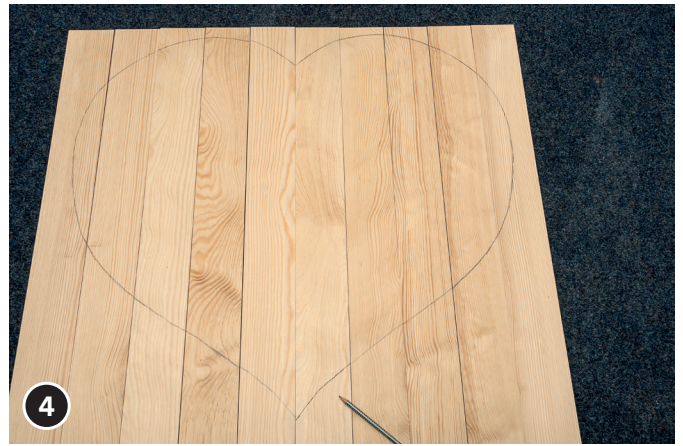
4 Avec un crayon, redessiner la forme du coeur, Scier les planches en forme de coeur. On va travailler les lattes en pin avec le marteau, les ciseaux à bois et la scie jusqu'à obtention d'un effet Vintage.
