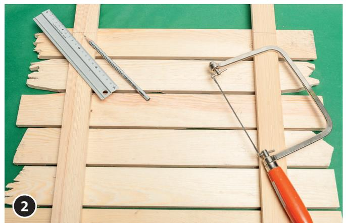
Die bearbeiteten Kieferleisten werden auf der Rückseite mit Nägel befestigt.
