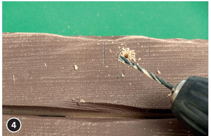
4 Auf der Vorderseite der zusammengefügt Kieferleisten, auf der oberen Kieferleiste, 3 Löcher für die Kiefernwürfel bohren.
