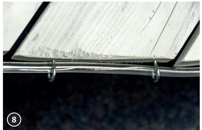
8 Die Ringschrauben soweit reindreihen, dass der Lichtschlauch noch hindurchpasst. Lichtschlauch von der inneren Mitte aus befestigen und außen herum legen. Das Batteriefach an der äußeren Kante auf der Rückseite befestigen. Die Befestigungsbügel zum Schluss an der Rückseite, zum Aufhängen, befestigen.
