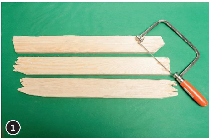
Die 6 Kieferleisten werden mit dem Hammer, Stechbeil und Säge solange bearbeitet, bis sie einen Vintage Effekt haben.
