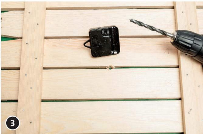
3 Mit der Bohrmaschine wird mittig ein Loch gebohrt und später das Uhrwerk zu befestigen.
