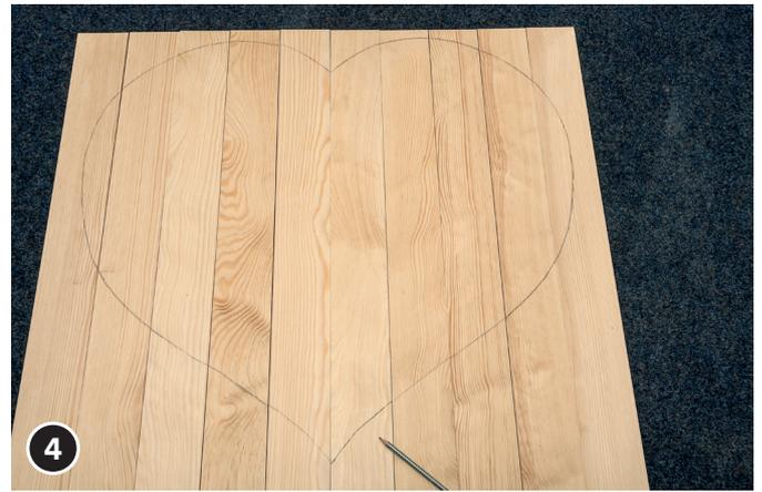
4 Mit einem Belistift abzeichnen. Die Bretter in Herzform zusägen. Die Kieferleisten werden mit dem Hammer, Stechbeil und Säge solange bearbeitet, bis sie einen Vintage Effekt haben.
