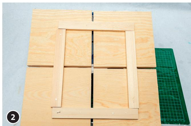
2 Kieferleisten auf der Rückseite mit Nägeln befestigen.
