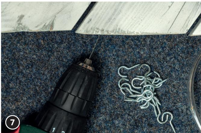
7 Im Abstand von ca. 10 cm mit der Bohrmaschine kleine Löcher vorbohren.
