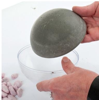
8. Nehmen Sie die äußere Kugelhälfte ab. Es kann sein, dass sich die Schalen durch die eingeklebten Klebesticks etwas schwer auslösen lassen. Ist dies der Fall, müssen Sie die Kunststoff-Schale mit einer Zange (Eisensäge, Laubsäge) aufschneiden. Lassen Sie den Beton vollständig austrocknen.
