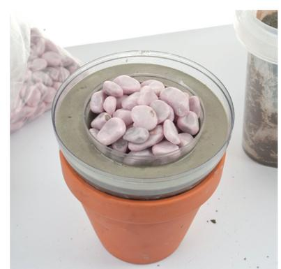
4. Warten Sie ca. 15 Minuten. Stellen Sie die kleinere Kugelhälfte mittig auf die Betonschicht. Denn entstandenen Zwischenspalt gießen Sie mit Beton aus. Lassen Sie nochmals die Luftblasen entweichen.
