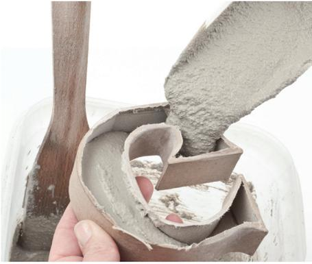
4. Befüllen Sie den Buchstaben mit Beton. Lassen Sie den Beton (je nach Modellgröße) ca. 2 Tage austrocknen.
