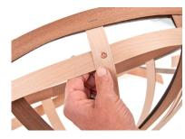
5. Verschlingen Sie die Furnierkanten miteinander und fixieren diese mit der Ösenzange und Ösen.
